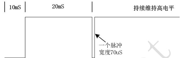
2.切换到D类防破音模式2的波形
