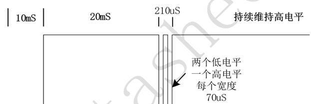
3.切换到D类防破音关闭的波形
