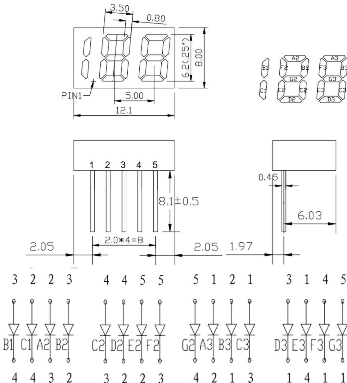
图 9 5pin 188 型数码管电路图
