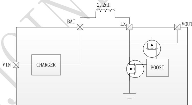
图 7 IP5513 路径管理示意图
