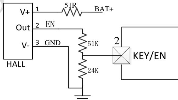
图 11 霍尔器件接线电路图
