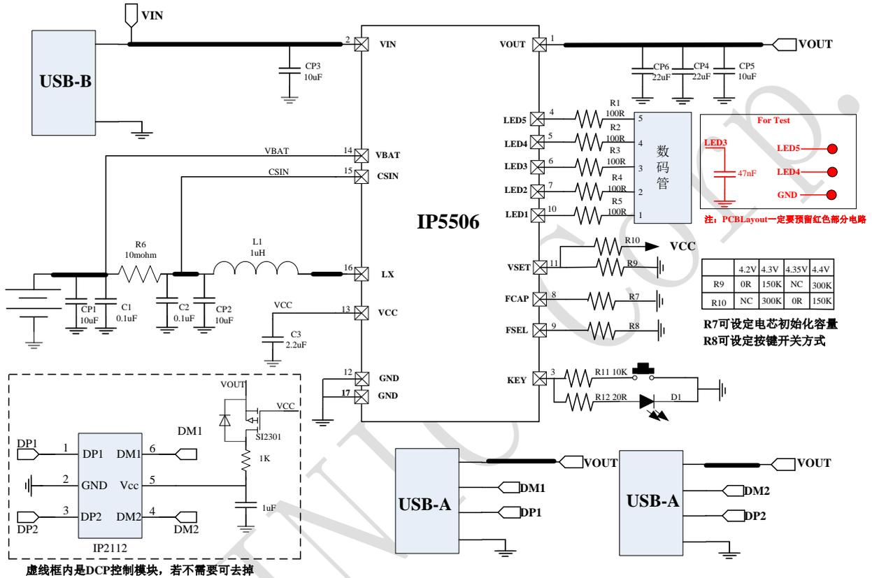
图 12 IP5506 数码管应用的典型应用原理图
