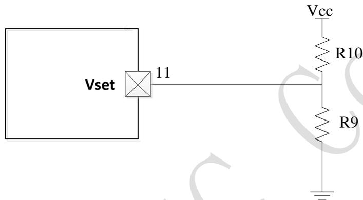
图 8 Vset 电池电压配置电路
