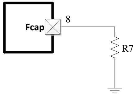
图 11 电池容量配置电路图
