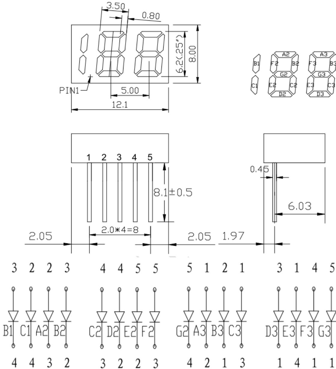
图 10 5pin 188 型数码管电路图
