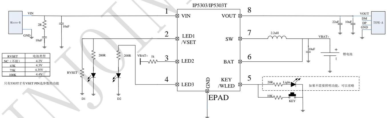
图2 2LED电量显示典型应用原理图
