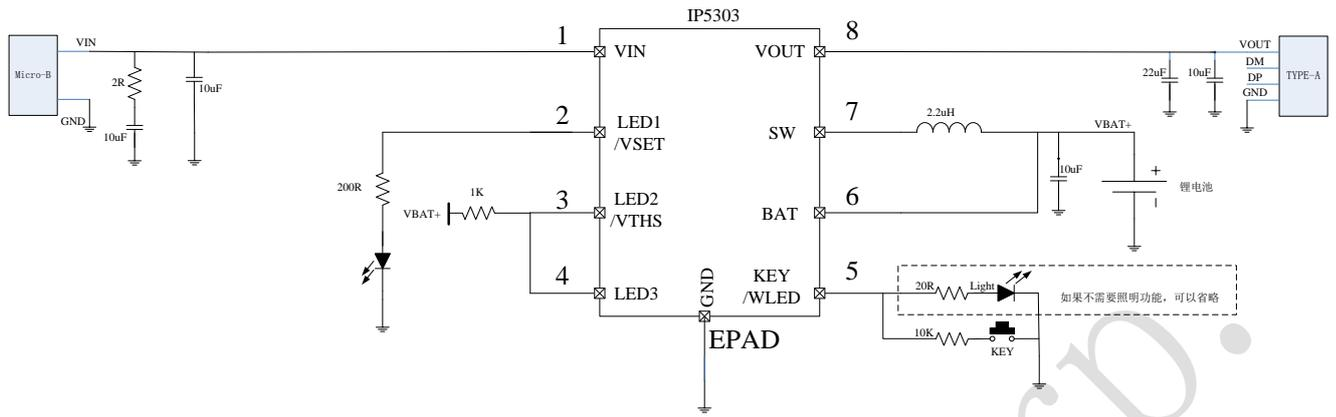
图4 1LED电量显示典型应用原理图
