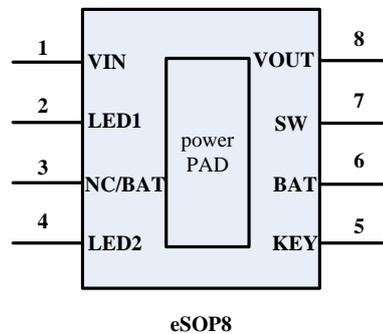
图 1 IP5303/IP5303T 引脚图
