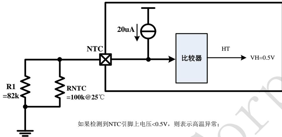
IP2726 集成 NTC 温敏电阻检测可检测设备温度，在工作的时候 NTC PIN 输出  $20\mu A$  的电流，同时检测 NTC PIN 脚的电压来判断当前温度。当温度异常时关闭功率路径上的 MOS 管，保护设备的安全。
