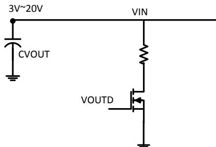
电阻大小根据实际情况取值，输出空载情况下 20V 降压到 5V 的时间要小于 OVP 阈值更新时间，否则可能会误触发 OVP 保护
