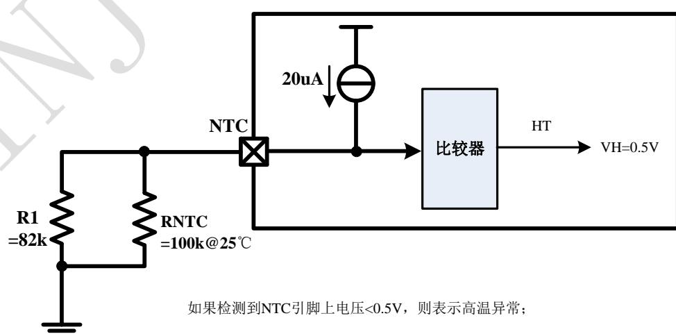
IP2723T 集成 NTC 温敏电阻检测可检测设备温度，在工作的时候 NTC PIN 输出 20uA 的电流，同时检测 NTC PIN 脚的电压来判断当前温度。当温度异常时关闭功率路径上的 MOS 管，保护设备的安全。
